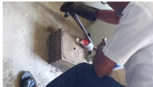
Fig 5.7 Pouring of molten metal
