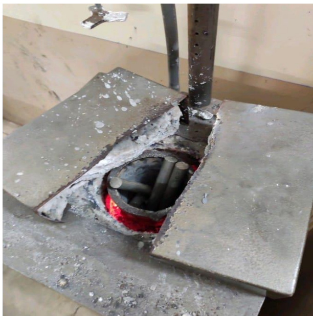
Fig: 3.6. Al7075 in Crucible
