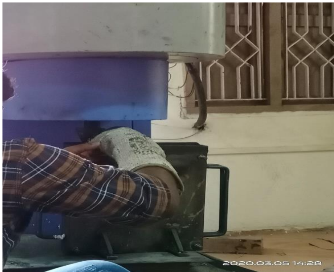
Fig: 4.11. Pouring the Molten Liquid into the 6 Finger Die
